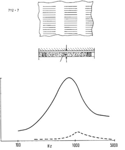
Fig. 5 - Curva di assorbimento di un risonatore multiplo di Helmholtz.
