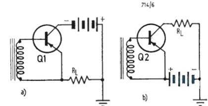
Fig. 2 - Circuiti equivalenti dei transistori  $Q_1$  e  $Q_2$  di fig. 1.
