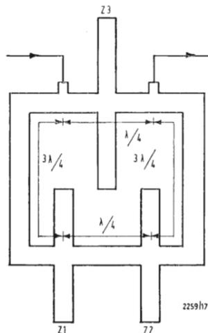
Fig. 15 - Schematizzazione del notch filter con i conduttori ed i pistoni coassiali. Il pistone  $Z_3$  serve a facilitare la regolazione.
