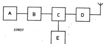
Fig. 1 - Principali componenti di un trasmettore televisivo: A oscillatore a cristallo; B moltiplicatore di frequenza; C amplificatore modulato; D amplificatore di uscita; E modulatore video.
