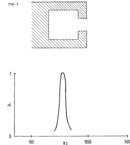
Fig. 3 - Curva di assorbimento di un risonatore Helmholtz.
