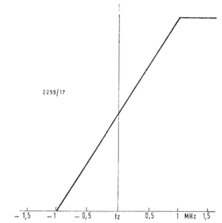
Fig. 9 - Caratteristica di ampiezza di un ricevitore televisivo normale. La caratteristica comincia a scendere a 1 MHz al di sotto della frequenza di trasmissione  $f_z$  e si annulla a 1 MHz al di sotto di questa frequenza.
