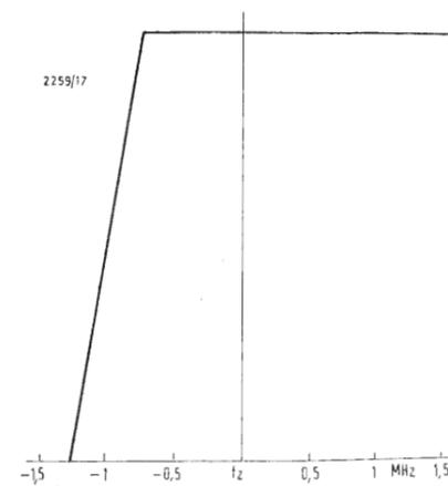
Fig. 8 - Schema della parte sinistra della caratteristica di ampiezza del trasmettitore video. Questa caratteristica resta piana fino a 0,75 MHz al di sotto della frequenza di trasmissione  $f_z$  e si annulla a 1,25 MHz al di sotto di  $f_z$ .
