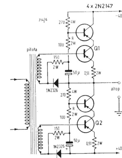
Fig. 3 - Stadio finale analogo a quello di fig. 1, ma con transistori supplementari a base in comune.
