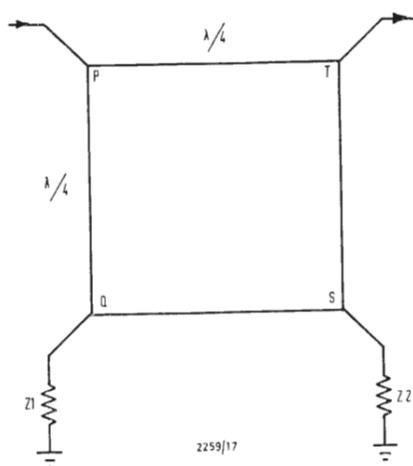
Fig. 14 - Schematizzazione del ponte utilizzato nel notch filter.
