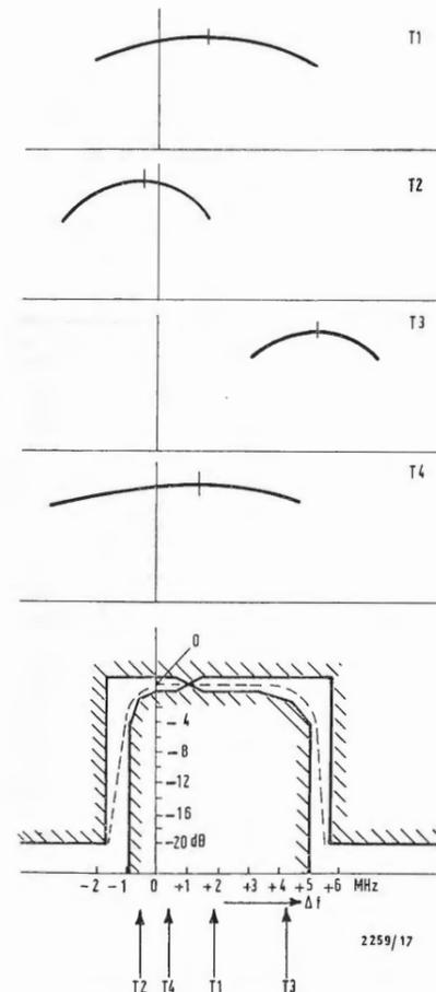
Fig. 6 - Gli accordi delle cavità sono tali che i massimi delle caratteristiche di ampiezza delle diverse cavità differiscono un poco dalla frequenza nominale del trasmettitore. La caratteristica di amplificazione totale del klystron assume allora la forma indicata in basso.
