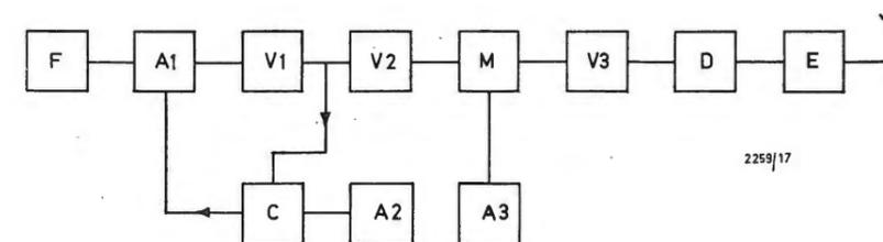
Fig. 2 - Principali componenti di un trasmettore audio a modulazione di frequenza: A<sub>1</sub> oscillatore modulato in frequenza; F amplificatore audio/modulatore; V<sub>1</sub> duplicatore di frequenza; C comparatore; A<sub>2</sub> oscillatore a cristallo; V<sub>2</sub> triplicatore di frequenza; M miscelatore; A<sub>3</sub> oscillatore a cristallo; V<sub>3</sub> duplicatore di frequenza; D amplificatore di potenza; E amplificatore di uscita.
