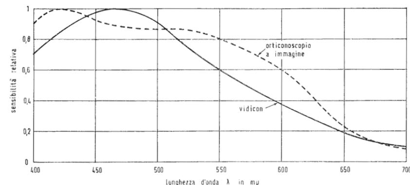
Fig. 5 - Curve di risposta spettrale di due tipici tubi da presa a colori. L'illuminazione è il bianco di uguale energia.
