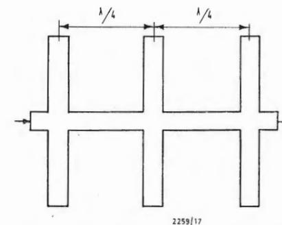
Fig. 13 - Nel filtro di Nyquist, tre pistoni coassiali sono montati nel conduttore coassiale ad una rispettiva distanza di un quarto di lunghezza d'onda.
