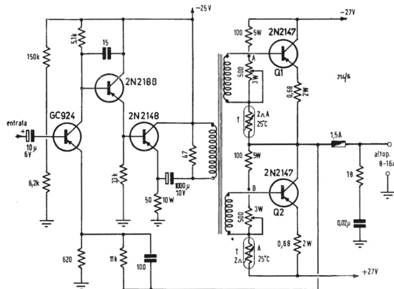
Fig. 1 - Stadio finale (2 x 40 W) senza trasformatore di uscita, ma con trasformatore di entrata interstadio.
