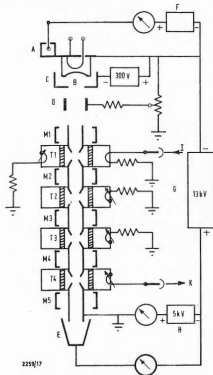
Fig. 4 - Sezione del klystron YK1001 e del suo montaggio. A pompa ionica; B catodo; C elettrodo di focalizzazione; D anodo di accelerazione; M<sub>1</sub> e M<sub>2</sub> magneti di focalizzazione; T<sub>1</sub>-T<sub>4</sub> cavità; F raddrizzatore alta tensione 13 kV; H raddrizzatore alta tensione 5 kV; I segnale RF dello stadio precedente; K segnale di uscita verso l'antenna.
