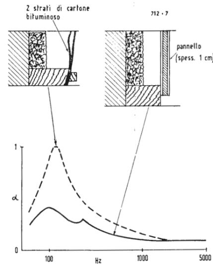
Fig. 2 - Curva di assorbimento di pannelli assorbenti.
